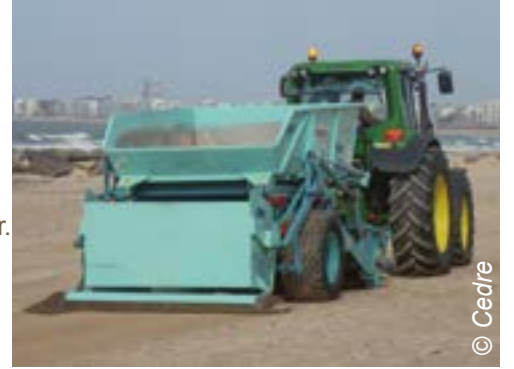
Traktör ile çalıştırılan büyük sahil temizleme makinesi
