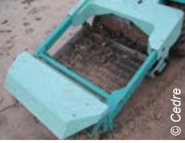
Küçük, kendiliğinden çalışan sahil temizleme makinesi
